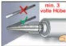
**5** Der Mörtelvorlauf ist nicht zur Befestigung der Ankerstange geeignet. Daher den Vorlauf solange verwerfen, bis sich eine gleichmäßig graue Mischfarbe eingestellt hat, jedoch min. 3 volle Hübe. Bei Schlauchfoliengebunden sind min. 6 volle Hübe zu verwerfen.
