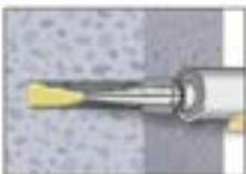
**6** Gereinigtes Bohrloch vom Bohrlochgrund her ca. zu 2/3 mit Verbundmörtel befüllen. Langsames Zurückziehen des Statikmischers aus dem Bohrloch verhindert die Bildung von Luftschlüssen. Wird der Bohrlochgrund nicht erreicht, muss eine passende Mischerverlängerung verwendet werden. Die temperaturrelevanten Verarbeitungszeiten (Anhang B 6) sind zu beachten.
