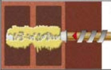
8. Befestigungselement mit leichten Drehbewegungen bis zur festgelegten Setztiefe einführen. Die Ankerstange muss frei von Schmutz-, Fett, Öl und anderen Fremdmaterialien sein.
